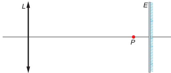
La distancia entre el espejo y la lente es 1,8 m. A 20 cm del espejo, sobre el eje, hay un punto luminoso,  $P$ , que se refleja en el espejo plano y su imagen se utiliza como objeto respecto a la lente. Dibuja la trayectoria que sigue un rayo de luz que parte de  $P$ . Calcula la posición de la imagen y el aumento lateral que se produce.
