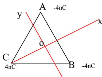
22.- Hallar el vector intensidad de campo en el centro de masas del triángulo equilátero de la figura, cuyo lado mide  $\sqrt{3} \text{ m}$ , estando situadas en sus vértices las cargas que se indican.
