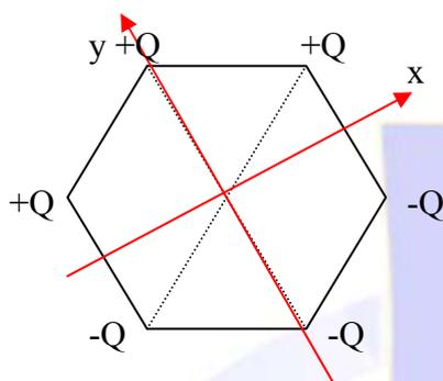
25.- En los puntos de la figura, referidos a un sistema plano de ejes coordenados y que corresponden a los vértices de un hexágono regular de 5 cm de lado, están situadas las cargas que se indican ( $Q=1 \text{ nC}$ ). Hallar el valor del campo eléctrico en el origen de coordenadas, que coincide con el centro del hexágono.
