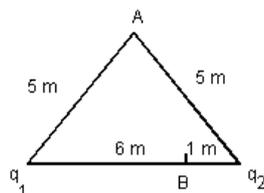
**CEL 8.-**En la figura adjunta se tiene que  $q_1 = 25 \cdot 10^{-9}$  C,  $q_2 = -25 \cdot 10^{-9}$  C. a)¿Cuál es el potencial en el punto **A**? b)¿Qué trabajo se ha de hacer sobre una carga de  $-8 \cdot 10^{-9}$  C para trasladarla del punto **A** al punto **B**? (Set. 89; Sel., Dep. Enseny., junio 89)
