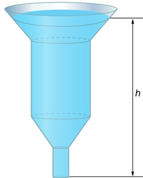
Calculamos la fuerza debida a la presión sobre la superficie circular del tubo de salida.
